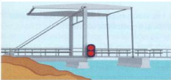
DOORVAART VERBODEN; BRUG BUITEN BEDRIJF Passage prohibited; bridge out of operation
